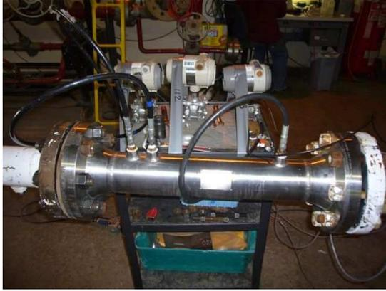
Fig 37a. Cone DP Meter Test Set Up
